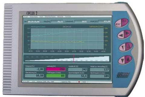
Abb. 20: Zeigen moderne Ergometer bereits Puls und Trainingsabschnitt an, arbeitet das CYCLUS-2 auch mit Laktatwerten und weiteren Parametern
