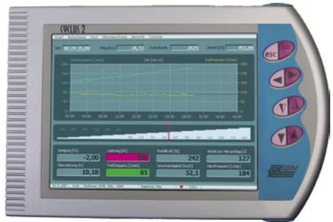
Ilustr. 20: Ergómetros modernos muestran no solo el pulso y el período de entrenamiento, sino p.ej: el CYCLUS-2 indica los valores de lactato y demás parametros.
