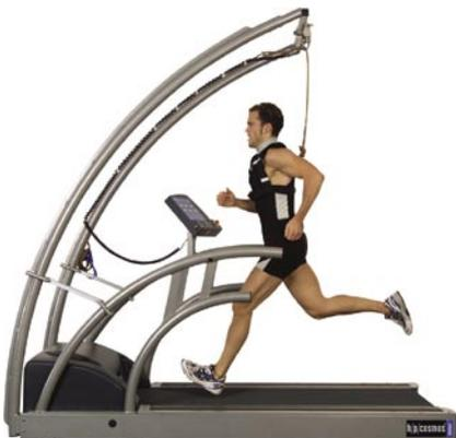
*Ilustr. 21: Banda rodante (h/p/cosmos pulsar) adecuada para el diagnóstico del rendimiento con gancho de seguridad*
