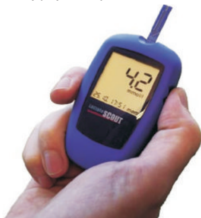
Ryc. 12: Przenośne analizatory zakwaszenia, takie jak Lactate Scout, są wiarygodne i przydatne do użytku w terenie
