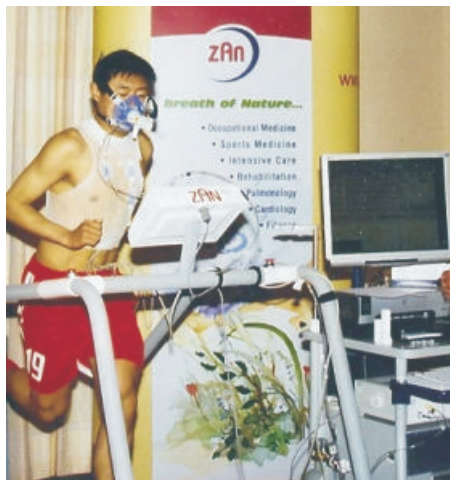
Ryc. 16: Ergospirometr ZAN-a, wspierany przez specjalny program analityczny
